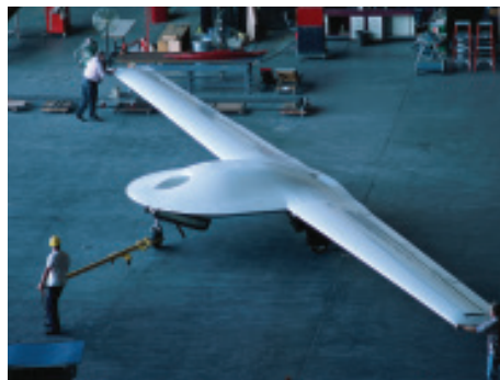
GETARNT DROHNE Die Darkstar (oben) wurde in den 1990er-Jahren von den Skunk Works entwickelt. Sie kann bis zu acht Stunden in einer Höhe von 14.000 Metern fliegen – kein Wunder, dass das Fluggerät bisweilen für ein UFO gehalten wurde.
