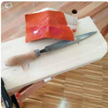
**07** Mit Holzfeilen und Schleifpapier die Kanten der runden Ecken sowie die Vorder- und Seitenkanten abrunden. Die abgerundeten Kanten geben dem Bord mehr Charme und Behaglichkeit. Ein Bord mit runden Ecken wirkt außerdem weicher und organischer. Ganz nebenbei holt man sich an abgerundeten Ecken keine blaue Flecken.
