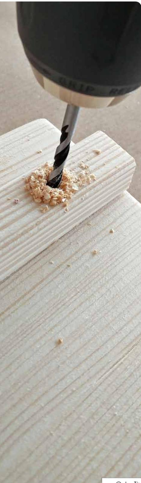
**11** Die 2,5 cm breite Leiste mit ca 2–3 cm Abstand zur Hinterkante auf dem zugesägten Brett platzieren. Das erste Loch mit dem Twercs® Akku-Bohrschrauber und dem Multizweck-Bohrer 4 mm bis zur Platte vorbohren.
