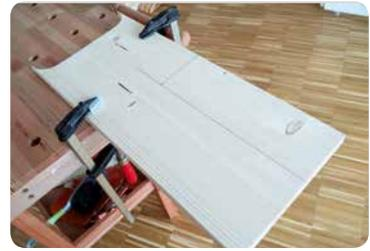
**18** Den Rest des Holzbretts einspannen, ca. 30 x 8 cm für das hintere Brett anzeichnen und aussägen. Genug Breite berechnen, dass die Schrauben, die von vorne die Löffel befestigen werden, Platz finden und auch nicht mit den Schrauben zusammenstoßen, die das hintere Brett befestigen. Abstand nach oben für die Befestigung der Bildaufhänger lassen.
