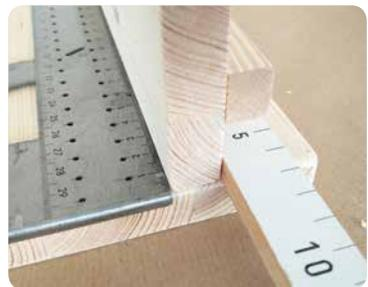
**15** Das Brett mit der Leiste auf dem anderen Brett auflegen und genau ausrichten. Die Unterkante anzeichnen.
