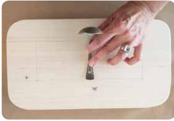
**15** Den ersten Löffel mittig positionieren und den Abstand zur Ober- und zur Unterkante ausmessen. Diesen Abstand auch als seitlichen Abstand für den linken und rechten Löffel nehmen und anzeichnen. Die Löcher für alle Löffel anzeichnen und leicht mit dem Twercs® Akku-Bohrschrauber und dem Multizweck-Bohrer 5 mm vorbohren.
