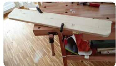
**06** Das Brett einspannen und mit dem Sägeblatt Clean Curve Wood SW104 S die Haken aussägen.
