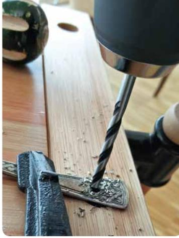
**10** Mit dem Twercs® Akku-Bohrschrauber und dem Multizweck-Bohrer 5 mm vorsichtig das Loch anbohren.
