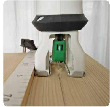
**04** Mit der Twercs® Akku-Stichsäge und dem Sägeblatt Clean Curve Wood SW104 S das Brett gerade absägen.
