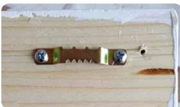
**22** An der Rückseite an allen 4 Ecken Bildaufhänger anbringen. Die unteren beiden
