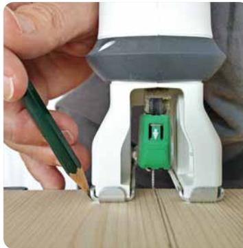
**02** Die Twercs® Akku-Stichsäge mit dem Sägeblatt Clean Curve Wood SW104 S an der gezeichneten Linie platzieren und die Außenkante der Säge anzeichnen.
