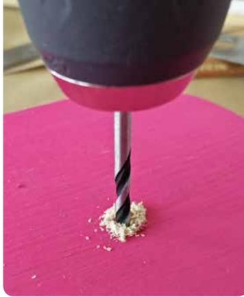
**24** Die Löcher für die Löffelhaken von der Vorderseite aus etwa bis zum hinteren Brett vorbohren. Nicht zu weit bohren, sonst halten die Schrauben nicht mehr gut.
