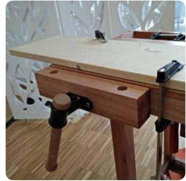
**04** Das Brett gut einspannen, sodass zunächst die beiden Ecken an der Brettkante ausgesägt werden können.
