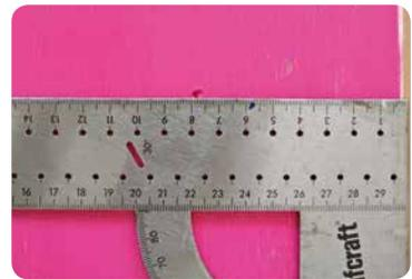
**19** Die Position der vorne angebohrten Löcher ausmessen und auf die Rückseite übertragen.
