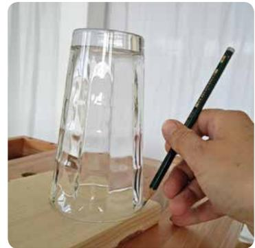
**05** Mithilfe eines Glases oder einer Tasse an der Vorderkante den Eckenradius anzeichnen. Sollte das Brett bereits eine abgerundete Kante vorgegeben haben, so sollte diese nach vorne und die Schnittkante nach hinten zeigen.
