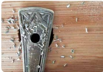
**11** Wenn der Bohrer gut greift, kann man mit voller Geschwindigkeit weiterarbeiten,
