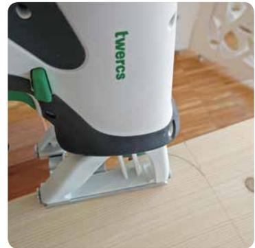
**05** Mit der Twercs® Akku-Stichsäge und dem Sägeblatt Clean Curve Wood SW104 S die ersten beiden Ecken aussägen. Dazu von außen kommend die laufende Säge ansetzen und langsam der angezeichneten Kurve folgen.
