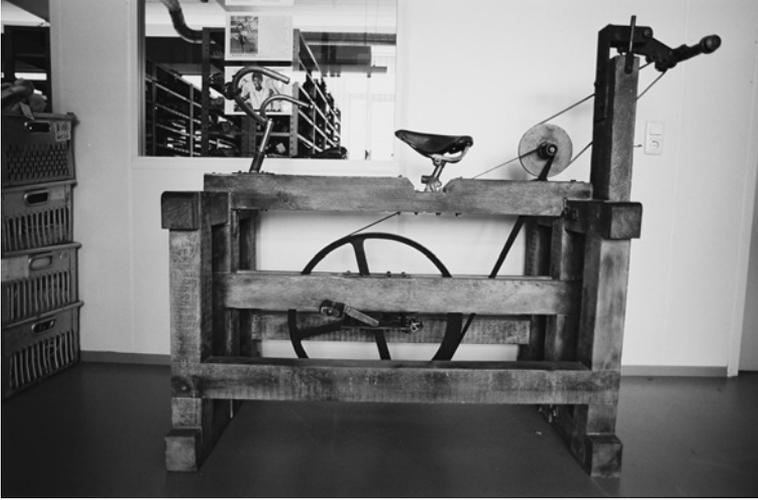
Not macht erfinderisch: Mit dieser Lederfräse bearbeitete Adi Dassler Schuhsohlen. Mangels Strom wurde das Ungetüm per Fahrradkurbel von sportlichen Mitstreitern angetrieben.
